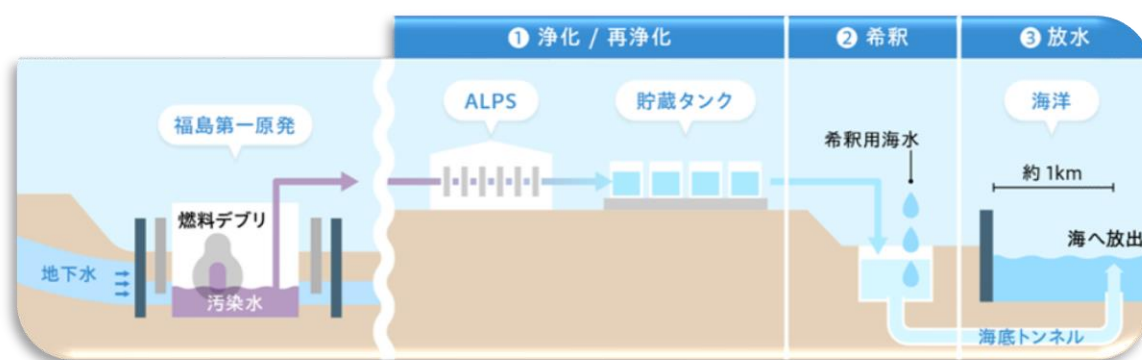
【図 1】ALPS 処理水を海洋放出する工程
